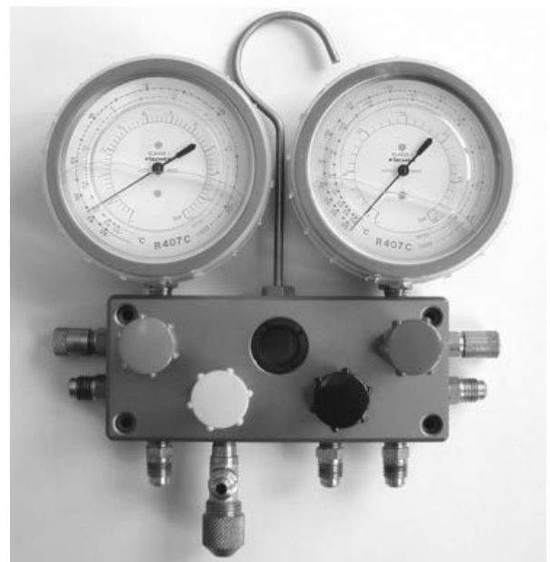
Fig. 7-10. Portique de manomètre
