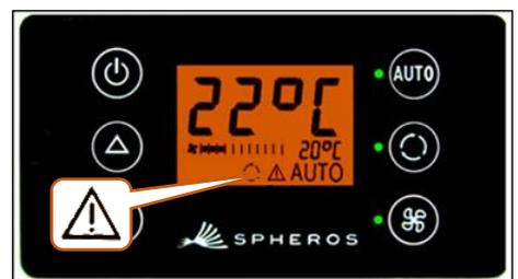
Abbildung 10 - SC600 Fehleranzeige
