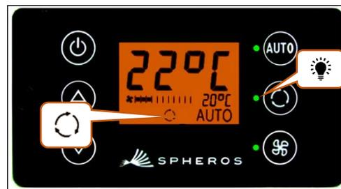
Ilustração 9 - SC600 função de circulação de ar ativado
