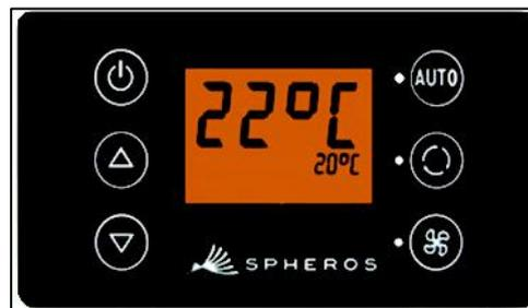
Ilustração 7 - SC600 modo automático desativado
