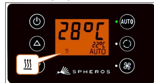
Ilustração 6 - SC600 modo automático ativado, calefação
