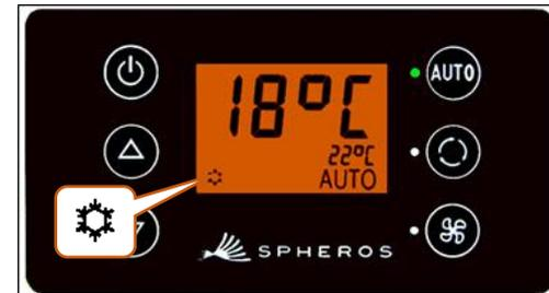
Ilustração 5 - SC600 modo automático ativado, refrigeração
