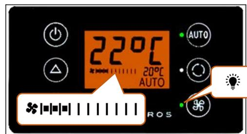
Ilustração 8 - SC600 regular a velocidade do ventilador manualmente
