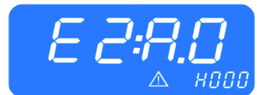
Abbildung 29 - SC1000 Fehler nicht behoben
