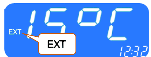
Abbildung 15 - SC1000 Außentemperatur anzeigen lassen
